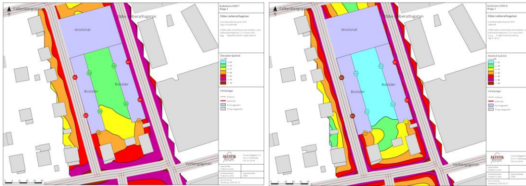
Utdrag ur bullerutredning, bostäder inom Krokslätt 23:15 och 23:20. Till vänster, ekvivalent ljudnivåer. Till höger, maximal ljudnivå.
